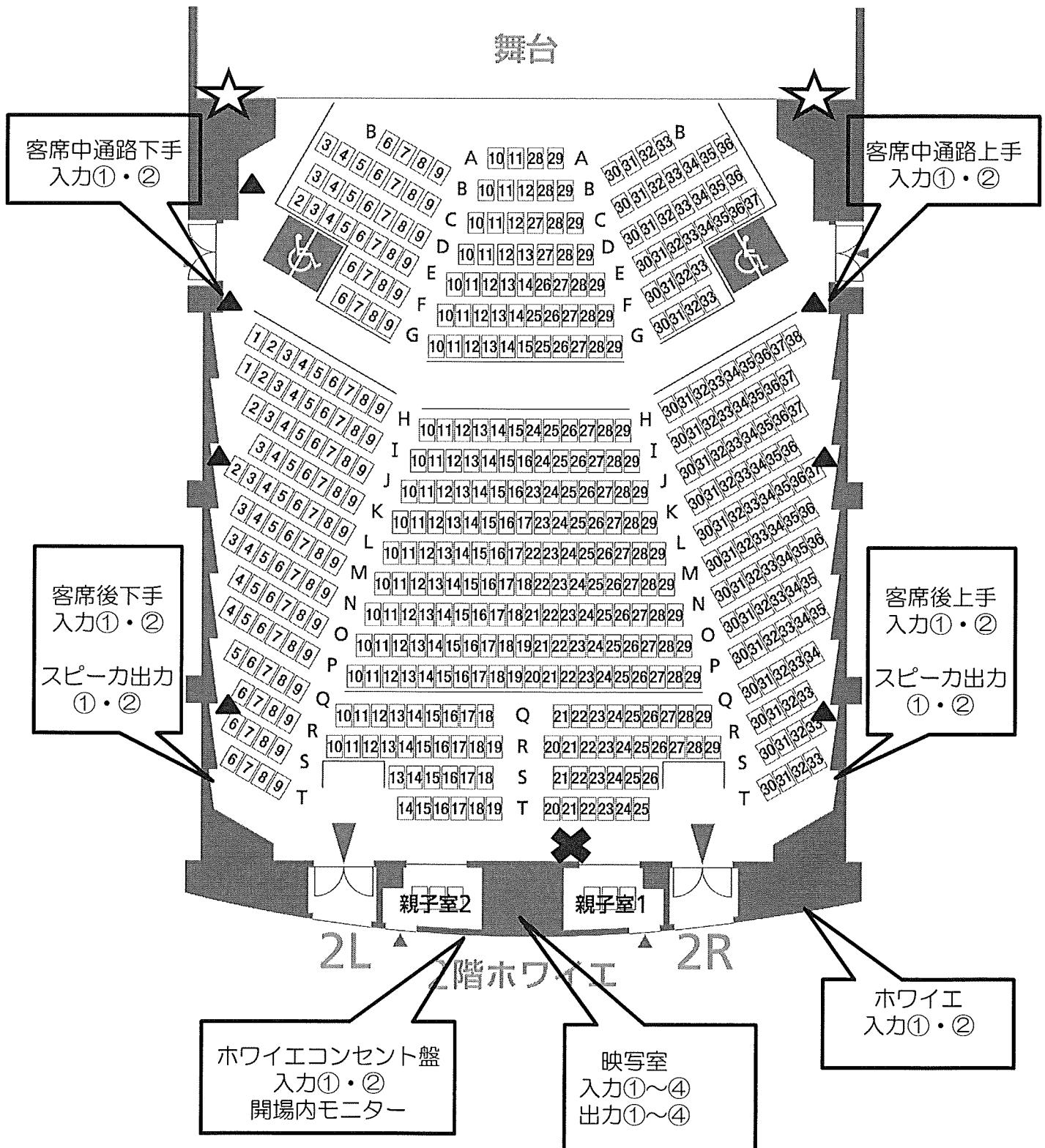
※他にはRH室①・②にマイク入力と出力回線が4系統ずつある。
